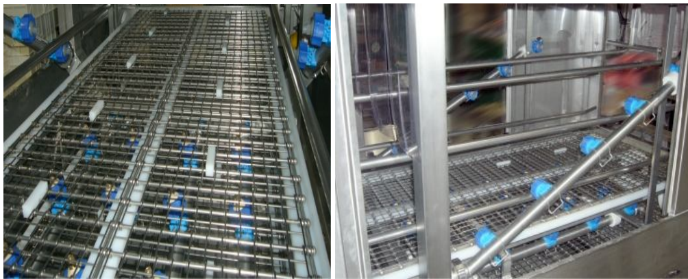
Фронтальный и боковой виды сетчатого конвейера с двумя рядами полиамидных захватов и коллектора с форсунками в моечном тоннеле
