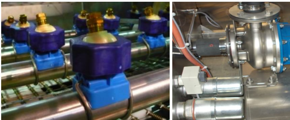
Регулируемые по направлению форсунки с латунными наконечниками с системой EasyClip в подвижном контуре в зоне основной мойки; ТЭНы и насос EBARA мощностью 4 кВт из нержавеющей стали
